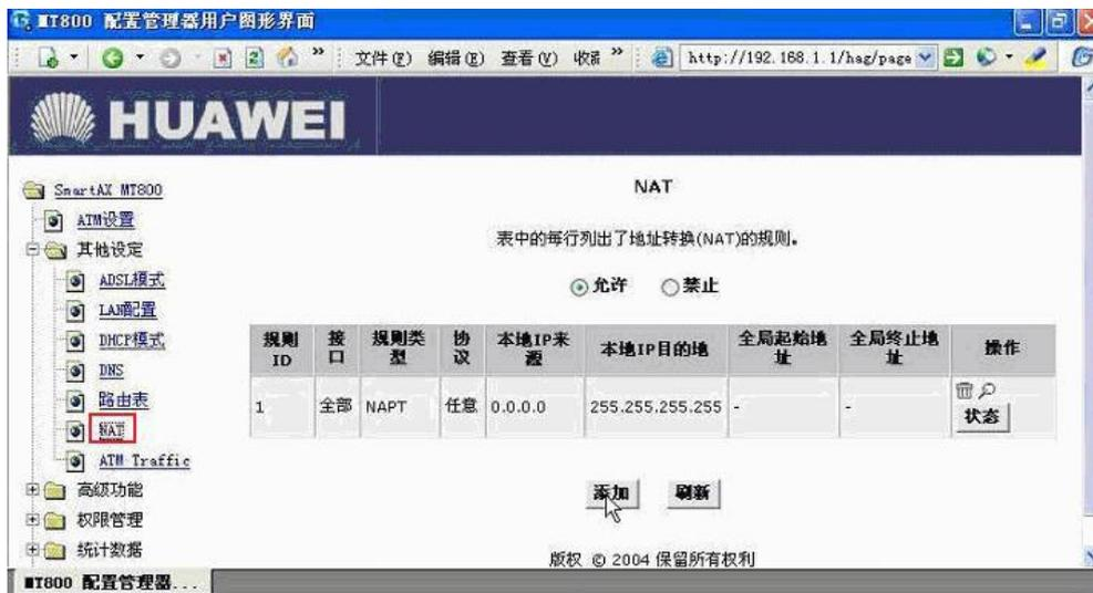
规则类型选择为：**REDIRECT**，协议：**TCP**，本地地址：**192.168.1.21**，全局起始及终止地址：**不需要填写**，起始端口和终止端口：**80**，然后点击**提交**。按照此操作继续添加**8003**和**8006**端口。
