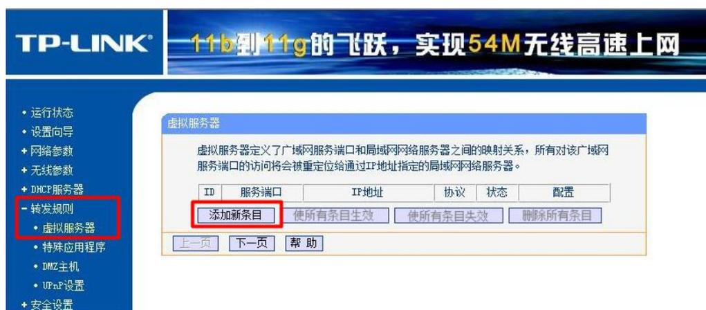
在服务端口号中填写 **80**，IP 地址填写 **192.168.1.21**，协议设置为 **TCP**（或直接选 **ALL**），状态必须设置为**生效**。常用服务端口号不用选择，然后点击保存。按照此操作继续添加 **8003** 和 **8006** 端口。
