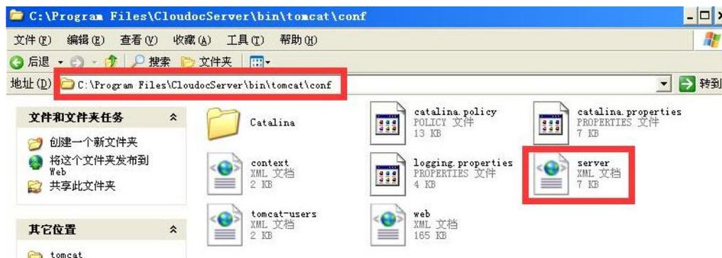
在 server 文件找到字段<Connector port="80" protocol="HTTP/1.1" connectionTimeout="20000" redirectPort="8443" />,将 port 的数值 **80** 修改为 **8088** (8088 是替代了 80, 且做了映射的端口号, 数值可自定义, 请选择非常用的端口号)。
